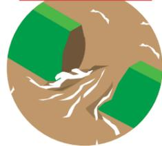
ため池の水位が上昇し、堤防を越えた水の勢いによって堤防が侵食され、決壊することがあります。流木が洪水吐の断面をふさぐと、堤防を越流しやすくなり、侵食・崩壊の可能性は一層高くなります。
