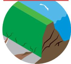
ため池の堤防が異常な力を受け亀裂が生じたり、地盤の液状化により決壊する可能性があります。比較的小さな地震でも、堤防の内部に生じた亀裂などにより強度が低下し、水圧に耐えきれずに決壊に至ることがあるので注意が必要です。
